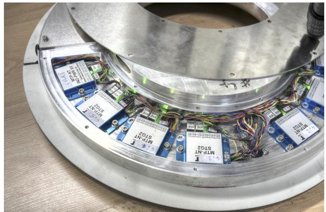
Applikationsbeispiel Zuverlässigkeitsmessung an Bahnradatz
