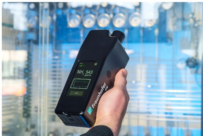
Wasserstoff kann in Form von Ammoniak (NH<sub>3</sub>) gespeichert und transportiert werden. Das Laserspektrometer von Fraunhofer IPM misst und wertet eine Absorptionslinie von Ammoniak aus und zeigt die Konzentration auf einem Display an.
