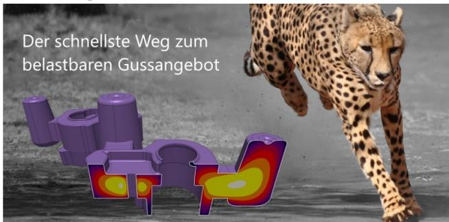
Machbarkeitsanalysen. Das Ergebnis besteht aus einer ganzheitlich gussgerechten 3D Gestaltung des Formhohlraumes. Das reduziert sowohl den virtuellen als auch realen Aufwand auf dem Weg zu einer prozessfähigen Gussproduktion.
