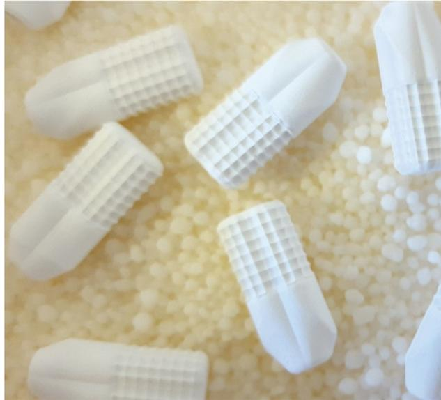
Rohlinge aus Yttrium-stabilisiertem Zirkonoxid (Schlickerguss).
