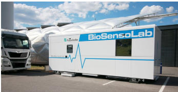
Mobile Laboreinheit mit integrierter Hub-einrichtung für Standard-LKW-Fahrgestelle
