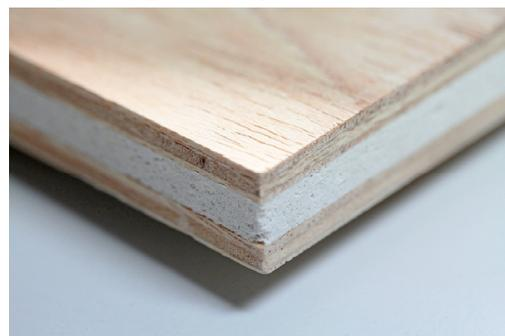
Die nichtbrennbare hybride Sperrholzplatte besteht im Inneren aus Blähglas und außen aus imprägniertem Fuma/Okoumé-Sperrholz.
