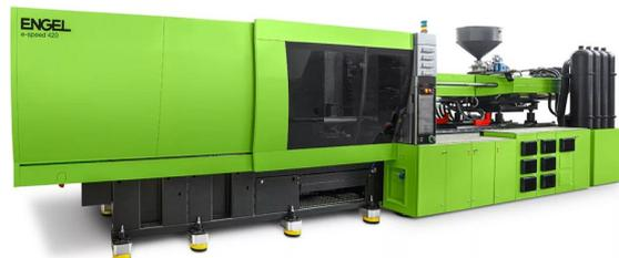
ENGEL e-speed Spritzgießmaschinen vereinen sehr kurze Zykluszeiten, höchste Präzision und sehr hohe Einspritzgeschwindigkeiten mit äußerster Energieeffizienz. Neu präsentiert ENGEL die e-speed 420 mit 4200 kN Schließkraft.
