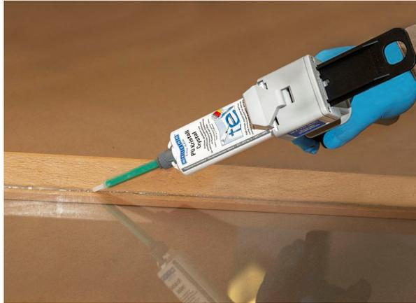
Dabei handelt es sich um einen glasklaren und farblosen Zweikomponenten-Polyurethan-Klebstoff. Der hochfeste und schnellhärtende Strukturklebstoff hat eine kurze Topfzeit von zwei bis vier Minuten und ist bereits nach ca. 30 Minuten schleif- und überlackierbar. PU Kristall ist beständig gegenüber Witterungseinflüssen und vielen aggressiven Chemikalien und temperaturbeständig von -40 bis +120 °C.
