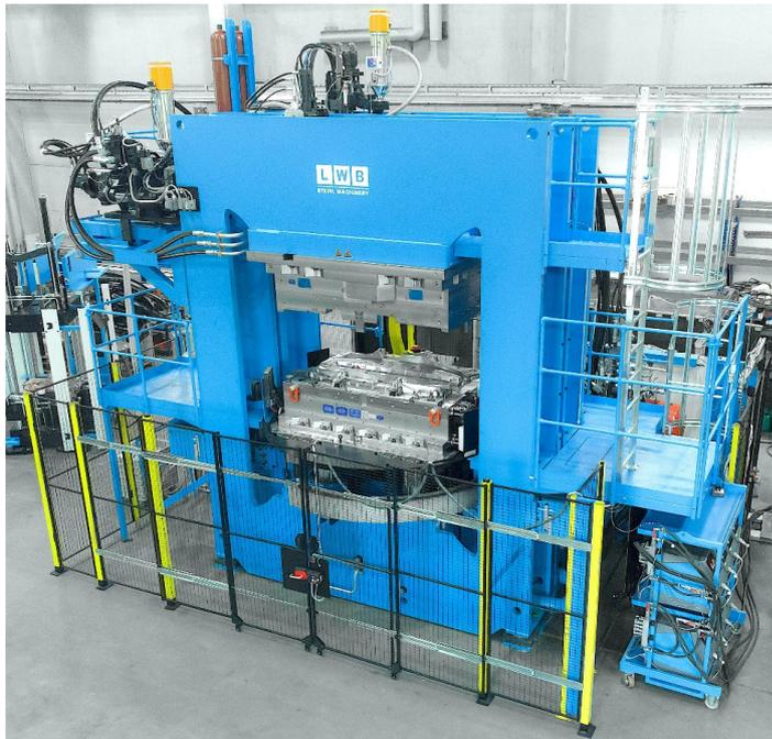
*Eine vertikale Portalrahmen-Rundtischmaschine mit zwei von oben einspritzenden Thermoplast-Spritzaggregaten hat sich bei einem global tätigen Autozulieferer als vorteilhafte Alternative zu konventionellen 2K-Horizontalmaschinen erwiesen*
