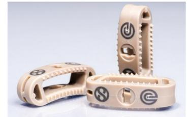
Cage-Prototypen aus dem Spritzgussverfahren demonstrieren die Designvielfalt bei Kunststoff-implantaten.
