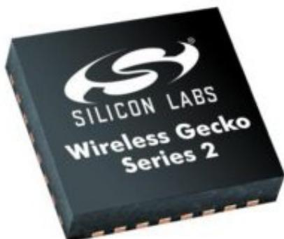
wird diesem Trend voll und ganz entsprochen. Die schlicht von Silicon Laboratories bezeichnete "Series 2" basiert auf der vorangegangenen Mighty Gecko Generation. Dabei hat sich die SoC Serie noch einmal verkleinert und präsentiert sich in einem 4 mm x 4 mm QFN-Gehäuse.
