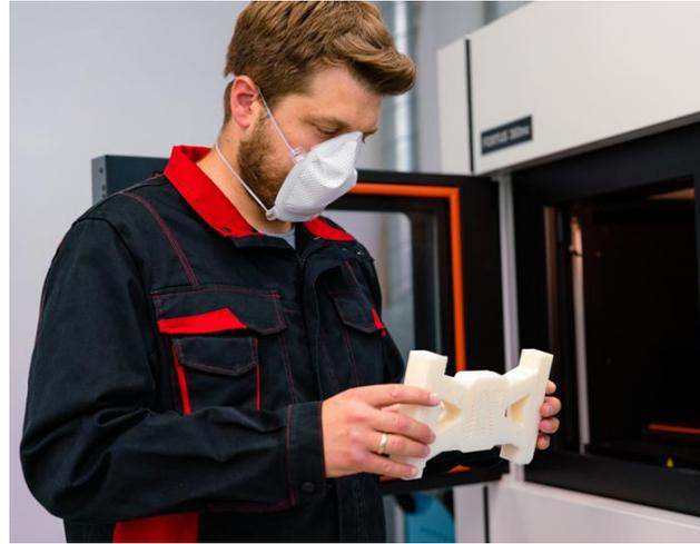
muster: ein mittels 3D-Druck oder wahlweise Spritzguss gefertigter Rahmen, in welchen unterschiedliche Vliesmaterialien eingelegt und nach Gebrauch getauscht werden können. Im Sinne eines sogenannten Lean-Startup-Ansatzes hat das Team bereits eine Kleinserie des funktionsfähigen Prototyps produziert und holt erstes Nutzerfeedback ein.
