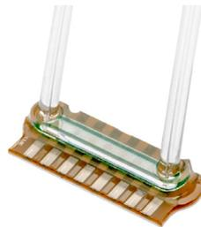
Kontinuierlicher multiparametrischer Biosensor mit 1 µl Messvolumen zum Einsatz in Kombination mit Mikrodialyse
