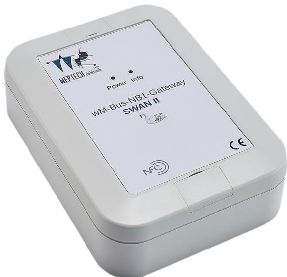
Als batteriebetriebenes Gateway ist SWAN 2 in der Lage drahtlose M-Bus Geräte über das Mobilfunknetz mit einem Anwender-Applikationsserver zu verbinden. Optional können auch kabelgebundene Schnittstellen wie L-Bus, RS-485 oder 2x Puls unterstützt werden. Die OMS-konforme, drahtlose M-Bus Schnittstelle unterstützt die Modi S-, T- und C mit Rahmenformat A und B.
