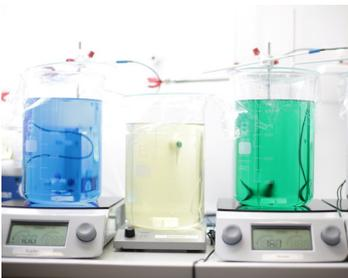
Metallisierung ist ein wichtiger Schritt bei der Herstellung von MID: Nacheinander werden Kupfer, Nickel und Gold chemisch auf die Leiterbahnen aufgetragen.
