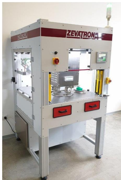
Der gesamte Arbeitsprozess wird überwacht. Bei Unterschreitung von Lottemperatur oder Lotniveau stoppt der Prozess automatisch. Optional wird das Niveau durch eine Lotnachfuhr konstant gehalten. Um die Oxidbildung zu minimieren, ist eine Ausrüstung mit Schutzgas möglich.
