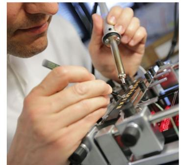
In seinem MID-Labor bildet das Fraunhofer IEM die gesamte Prozesskette der MID-Herstellung ab (Hier wird ein MID-Bauteil bestückt).
