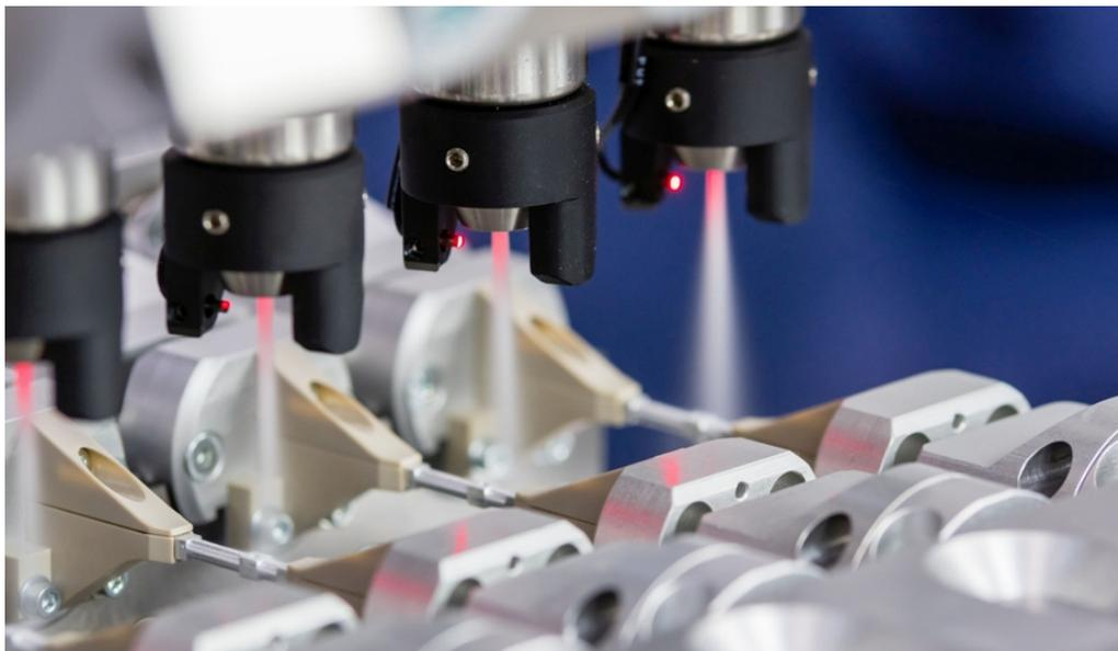
*Das Industrie 4.0-kompatible Verfahren lässt sich in automatisierte Fertigungsumgebungen integrieren und die Qualität des Reinigungsstrahls kann mit Sensoren überwacht sowie in einen digitalen Wert übertragen werden.*
