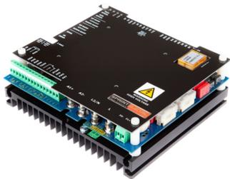
*Vier-Quadranten-Gleichstromrichter 3600XRi von Sprint Electric – jetzt mit Deckplatte*
