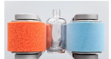
Der Zahnriemengurt mit Sylomer-Beschichtung lässt Flaschen zwischen zwei Förderbändern schweben
