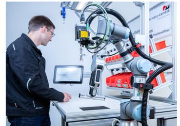
Arbeiten als Team: Bei der Baugruppenmontage übernimmt der Cobot nachgelagerte Arbeitsschritte und entlastet den Werker.
