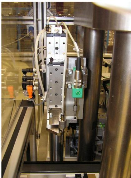
Je nach Anwendung sind die Bohrungen so über den Hub angeordnet, dass die Masse mit konstanter Dämpfungskraft verzögert, die kinetische Energie also gleichmäßig über den gesamten Hub abgebaut wird. Die konstante lineare Kennlinie geht mit der geringsten Belastung für die Maschine einher. **Halle 5, Stand 5223**
