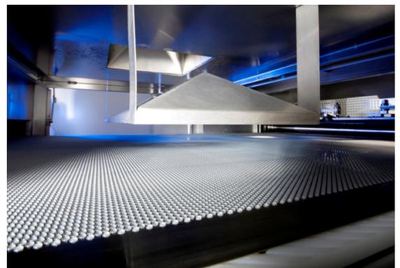
*Der Rotoform pastilliert Schmelzen mit einer Viskosität von bis zu 40.000 mPas*
