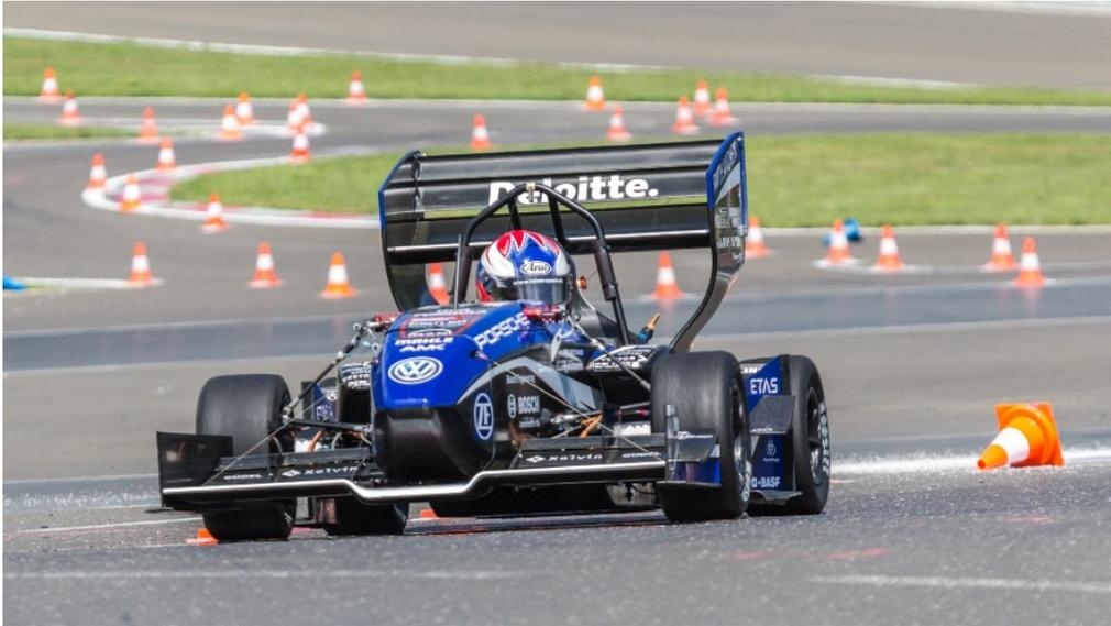
Elektro-Rennwagen „eace05“ des Ecurie Aix - Formula Student Teams der RWTH Aachen - ohne Laser nicht denkbar: Er enthält lasergeschweißte Batterien sowie lasergeschnittene CFK-Bauteile.
