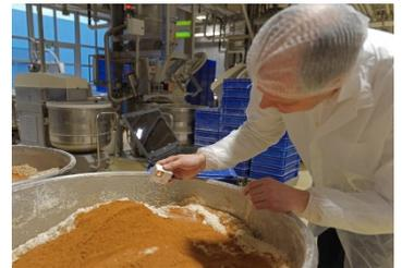
Handliche Mikrospektrometer (optional auch mit Bluetooth-Verbindung) erlauben die Realisierung praktikabler Handheld-Applikationen
