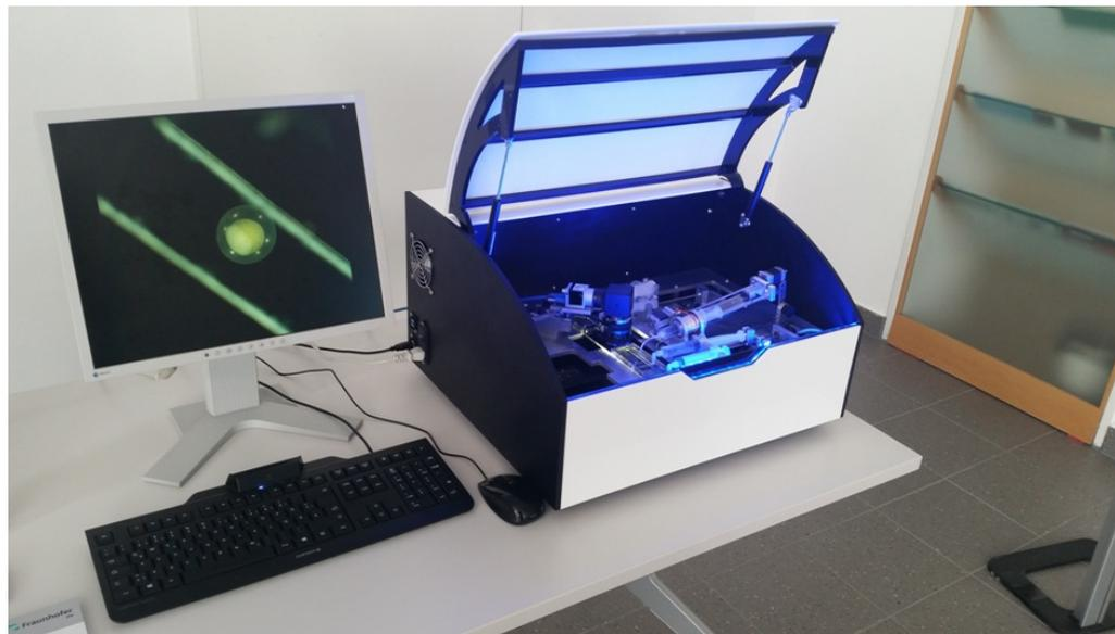
Prototyp des Fischei-Sortierers. Der Apparat erkennt mithilfe eines Kamerasystems und Machine-Learning-Algorithmen, ob die Eier von Zebrafischen befruchtet sind oder nicht und sortiert diese entsprechend.
