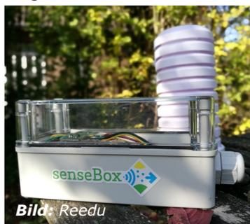
verschiedener Sensoren wie Temperatur, Luftfeuchtigkeit, UV-Strahlung, Lautstärke, Feinstaub u.v.m. untersucht werden. Die Messwerte können direkt ins Internet an die openSenseMap - unsere offene Webplattform für Sensordaten- übertragen, runtergeladen und analysiert werden.
