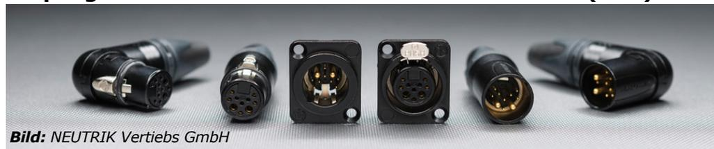
Die 10-poligen XLR von Neutrik sind eine robustere und einfach zu verarbeitende Alternative zu den RJ45-Steckverbindern. Die Kontakte 1 bis 8 sind zur Datenübertragung nach CAT5e vorgesehen und können analog zum RJ45 belegt werden. Über die zwei massiven Kontakte 9 (+) und 10 (-) können bis zu 16 A und 50 V übertragen werden. Die PoE-Werte werden damit deutlich übertroffen.
