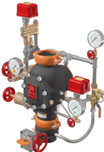
Victaulic wird seine hochentwickelten Produkte für den Brandschutz auf der Messe präsentieren, wie beispielsweise die Trockenalarmventilstation FireLock NXTM. Das System kontrolliert den Wasserfluss in frostgefährdeten Sprinkleranlagen und arbeitet dabei mit besonders geringem Betriebsdruck. Aufgrund des fehlenden Luft-Wasser-Differentials für die Verriegelung löst die Anlage im Brandfall schneller aus und verhindert Fehlauflösungen bei Druckstößen. Das erhöht die Betriebssicherheit des Systems.
