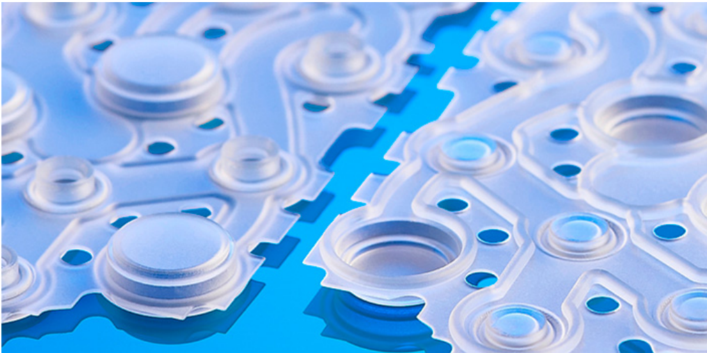
Steuerungs- und Dichtungsmembranen werden in medizinischen Pumpen eingesetzt. In das spritzgegossene Silikonbauteil wurden sowohl Dichtlippen als auch Steuerungspins integriert.
