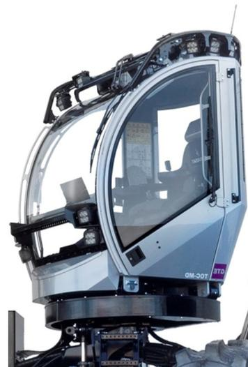
Wenn die Sägekette reißt, kann es in der Kabine eines Harvesters wirklich unangenehm werden: Wenn man von einem abgerissenen Kettenglied getroffen wird, hat das die gleichen Auswirkungen wie ein Treffer mit einer Pistolenkugel
