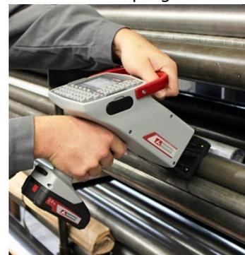
Das mobile Markiersystem kann durch sein geringes Gewicht wie ein herkömmlicher Akkuschauber über das Werksgelände getragen und zum Bauteil gebracht werden. Dies ist vor allem bei der Kennzeichnung von großen Werkstücken hilfreich.
