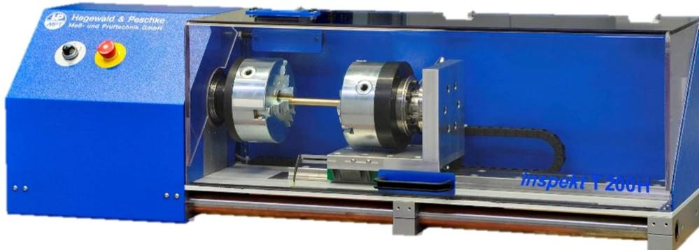
Das Torsionsprüfgerät kommt in Wissenschaft, Forschung und Lehre, in Prüflaboren und in der fertigungsbegleitenden Produktionskontrolle zum Einsatz.
