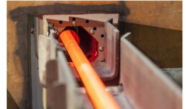
Sensoren erzeugen Daten. Bei der Herstellung von Rohren, Draht und Stabstahl werden bis zu 5.000 Konturen pro Sekunde über Laserschnittsensoren ermittelt, aus denen bei laufender Produktion ein hochauflösendes 3D-Modell erzeugt wird.
