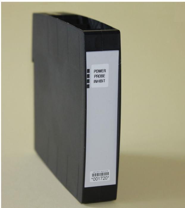
Diese Sonden verfügen über eine Kommunikationsschnittstelle mit CAN-Bus. Stickoxidsensoren sind generell empfindlich gegen Wasserdampf und Kondensat. Unmittelbar nach Motorstart ist die Wasserschlaggefahr am höchsten.
