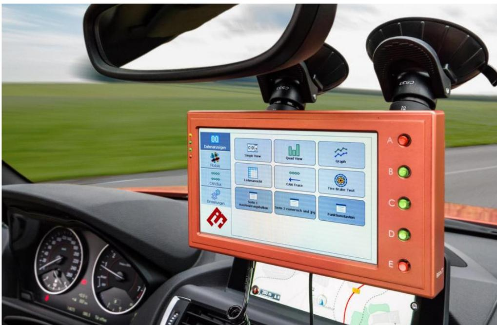
Das kombinierte Mess- und Anzeigesysteme GPS100View wird einfach an der Windschutzscheibe montiert und führt den Fahrer mit grafischen und akustischen Anweisungen durch den Versuchsablauf.
