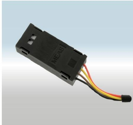
Die Feuchtemessmodule geben die relativen Feuchtigkeits- und die Temperaturwerte als digitale Signale im I<sup>2</sup>C Format aus. Die Auflösung der HTU(F)383X kann mittels Programmierung (8/12bit: Feuchte bis zu 12/14bit Temperatur) eingestellt werden. Die Genauigkeit ist mit ±2 % R.H. im Bereich zwischen 5% und 95% R.H. und die Langzeitdrift mit typ. 0,5% R.H./Jahr angegeben, was für die Feuchtigkeitsmessung ausgezeichnete Werte sind. **Halle 1, Stand 1-340**
