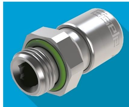
Die spezielle Dichtungstechnik des Programms 17A mit zwei Dichtungen aus FKM (Viton) in der Spannzange kann sowohl Gasinnendrücken bis 24 bar als auch Vakuum bis  $-0,95$  bar standhalten. **Halle 11.0, Stand E34a**
