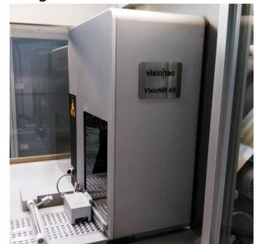
*VisioNIR AS Inspektionssystem – installiert auf einer Blisterverpackungsmaschine*
