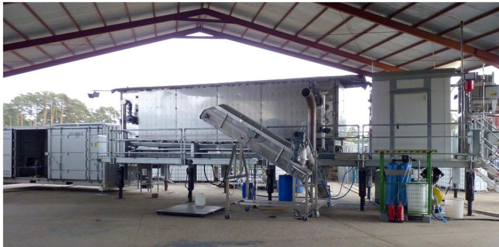
Pilotanlage zur Torrefizierung von lignocellulosehaltigen Rohstoffen.
