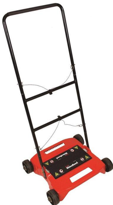
Die zweite Innovation betrifft das RhinoBond TellerMarkierungsgerät; es wurde zur Erkennung und Markierung der Schweisspunkte entwickelt. Es dient dem Dachdecker, die unter der Dachbahn installierten RhinoBond Lastverteilteller leicht zu lokalisieren und vorübergehend zu markieren.
