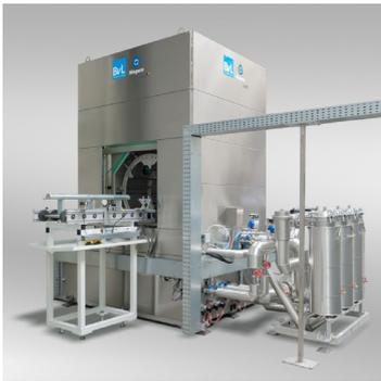
Zur Vorreinigung werden die Motorblöcke in der Spritzreinigungsanlage „NiagaraFS“ von außen gründlich gereinigt.
