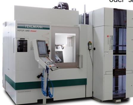
Auf der EMO 2017 wird die VERSA 645 linear als Zweimaschinen-Automationsanlage gezeigt in Kombination mit der grösseren VERSA 825 und mit dem Erowa Robot Compact 80. Beide 5-Achs Bearbeitungszentren sind je mit einem Regalmagazin für bis zu 225 bzw. 250 Werkzeuge ausgerüstet.
