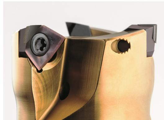
Die hochpositive Geometrie der Schneidplatten sichert einen besonders weichen Schnitt. Werkstück und Werkzeug werden damit minimal belastet. Eine hohe Standzeit und eine nahezu gratfreie Bearbeitung, besonders bei langspannenden Werkstoffen, sind dadurch gewährleistet.
