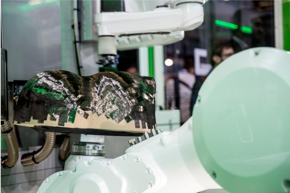
Vollautomatische Produktion komplexer Geometrien mit der Fiber Patch Placement Anlage SAMBA.
