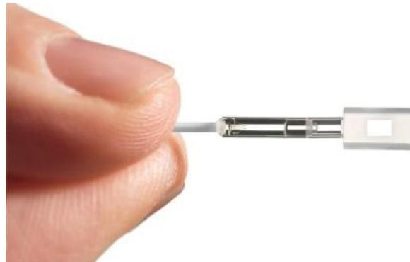
beruht auf der Tatsache, dass Schallwellen die Wellenlänge des Lichtes beeinflussen. Bei diesem Funktionsprinzip gibt es keine beweglichen Teile, insbesondere keine Membran und somit auch keine mechanischen Resonanzen. Das Messverfahren ist prinzipbedingt linear und arbeitet von 10 Hz bis zu sehr hohen Frequenzen von ca. 1 MHz in Luft und 20 MHz in Flüssigkeiten.
