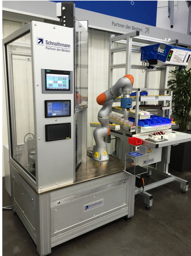
Das neue Werker-Assistenzsystem cubu:S von Schnaithmann mit Bewegungserkennung und Roboteranbindung
