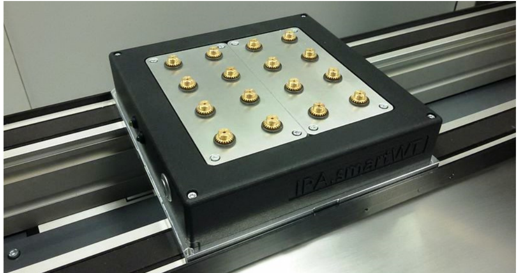
Der intelligente Werkstückträger „IPA.smartWT“ erfasst qualitätsrelevante Logistik- und Prozessdaten und übermittelt sie drahtlos nach außen.
