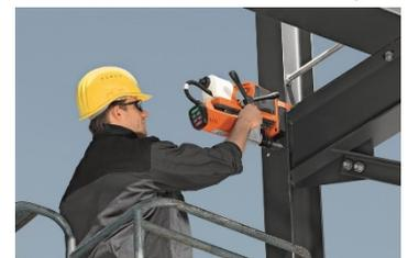
KBU 35 Baureihe: kompakte, leichte Universal-Kernbohrmaschinen
