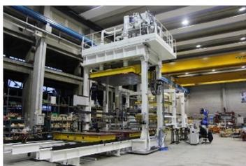
Vollautomatische Cannon Preformer für Kohlefasern zeichnen sich durch schnelle Zykluszeiten aus.
