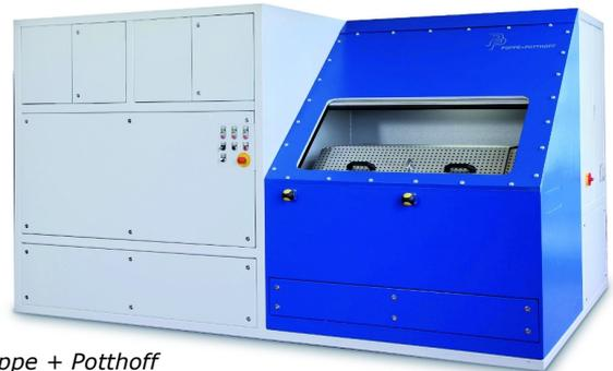
Poppe + Potthoff entwickelte eine kompakte Impulsprüfanlage mit Sicherheitskammer für Tests in Benzin bei Impulsen von bis zu 2000 bar. Optional können in einer zweiten Kammer Prüfungen in Öl simultan in einer Frequenz bis 10 Hz erfolgen.
