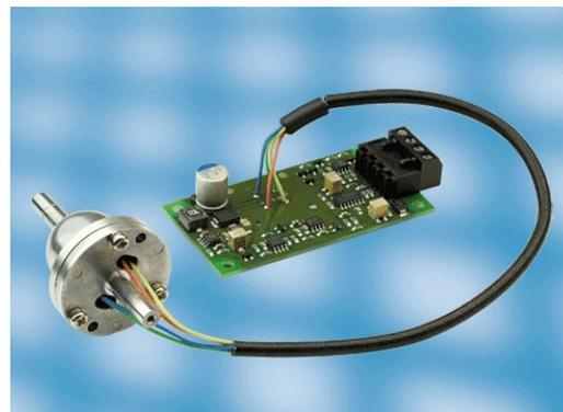
Das Schlüsselement des Sensormoduls ist der Sauerstoffsensoren von Fujikura, ein amperometrischer Halbleitersensoren (Zirkonium) mit hoher Ausgabegenauigkeit, einer kurzen Reaktionszeit bei Veränderungen der Gaskonzentration und Robustheit gegen Druckschwankungen, Feuchtigkeit und andere Gase. Das unverstärkte Signal des Sauerstoffsensors ist linear und bewegt sich im Mikro-Ampere-Bereich.
