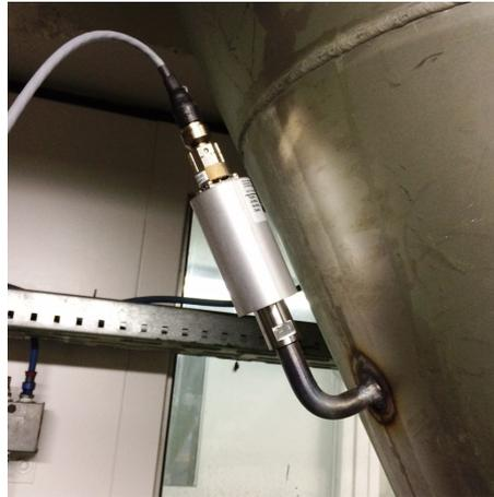
*Neue Technology: Ultraschall unterstützter Produktaustrag mit Oberflächenreinigung*
