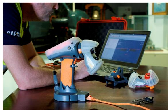
GapGun Link vereinfacht das Messdaten-Management im Produktionsablauf, indem es eine nahtlose Anbindung des Messsystems an ein zentrales Produktionsdatensystem ermöglicht.
