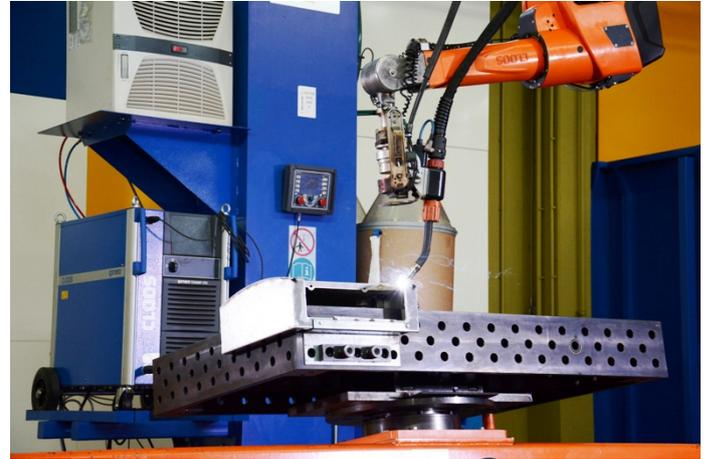
*Die erhöhte Abschmelzleistung bei Cold Weld resultiert in enormen Schweißgeschwindigkeiten – insbesondere bei dünnen Blechen.*
