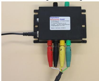
Damit können nun auch Kfz-Werkstattbetrieben Luftmassenmesser einfach überprüfen. Weitere Anwendungsgebiete sind die Überwachung von Strömungen in Luftkanälen, in der Gebäude- und Klimatechnik, die Überwachung des Luftpfades bei Stationärmotoren und Blockheizkraftwerken (BHKW) und bei Motorprüfständen. FlowSupply ermöglicht die Strömungsüberwachung mit einem einfachen Multimeter oder einer analogen SPS-Karte.
