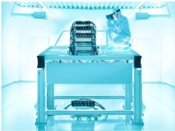
Die Stahlzukunft im Visier: Für das Projekt OSLO entwickelt LIMO einen 35 kW-Halbleiterlaser mit anspruchsvoller Strahlformung sowie hoher Strahlqualität (im Bild ein 15 kW-System), der künftig Stahlbandoberflächen gezielt und energieschonend beeinflussen soll.
