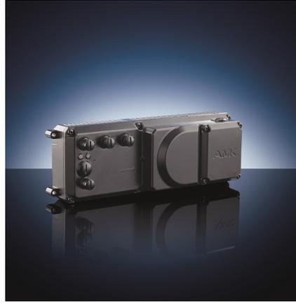
Mit der dezentralen Steuerung iSA ist es möglich alle Komponenten der Automatisierung direkt im Maschinenmodul zu verbauen und die Schnittstellen reduzieren sich auf einen Realtime Ethernet Anschluss zur Aufnahme in den Steuerungsverbund und einen Drehstromanschluss mit 3x400VAC. Für das Maschinenmodul bietet die iSA von AMK eine DC-Bus-Versorgung für Servoantriebe als auch eine integrierte 24-V-Versorgung und natürlich die Steuerungsintelligenz inklusive Motion Control.
