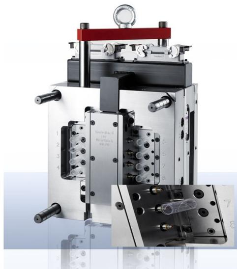
Alle Düsen sind einzeln regelbar und somit für ein gleichmäßiges Öffnen und Füllen aller Kavitäten optimal einstellbar.
