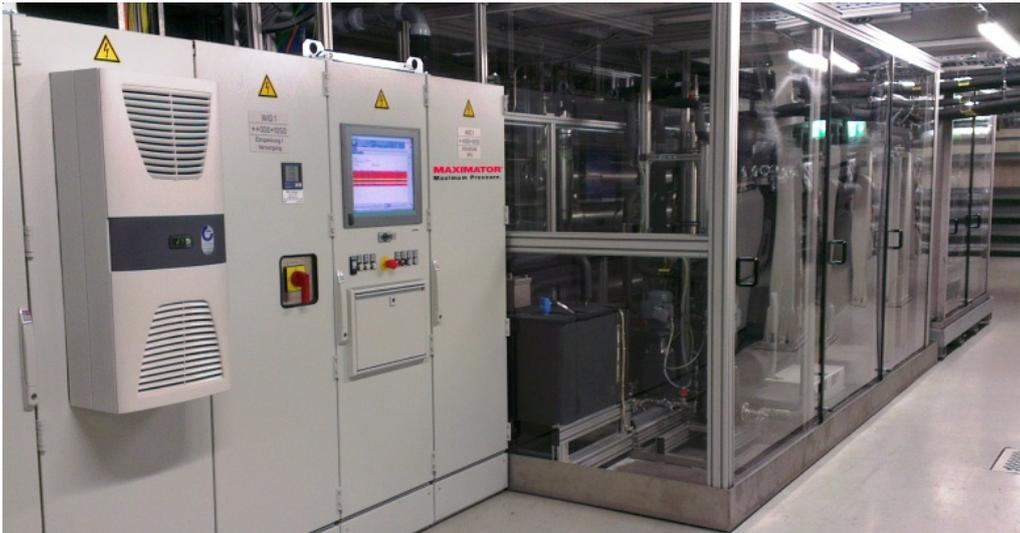
Maximator adaptierte eine Wasserinnendrucktechnik-Anlage für Strukturbauteile aus Faserkunststoffverbund im BMW Group Werk Landshut.
