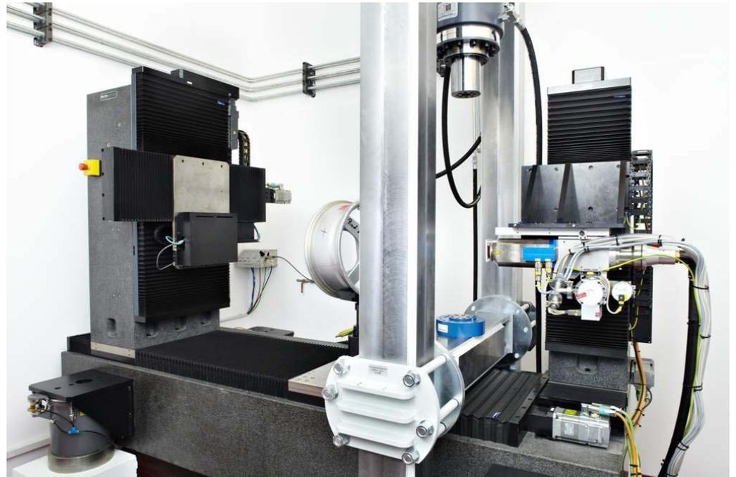
Der Computertomograph im Fraunhofer LBF prüft große Probestücke im realen Einsatz
