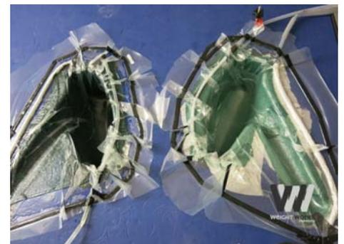
Simultane Fertigung zweier Außenschalen einer CFK-Airbox für den Rennsport mittels Vakuum-Infusionsverfahren (Negativform mit unserem Verfahren aus Hartschaum Urmodellen erzeugt)
