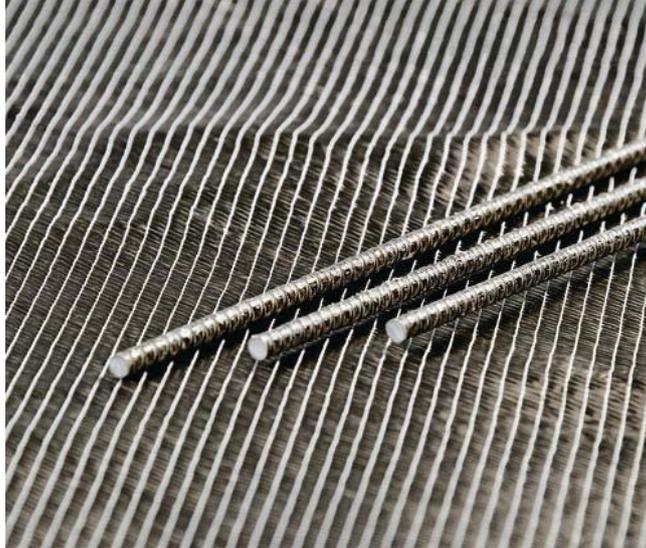
Basaltfaserwerkstoffe: Faszinierende Fasern aus Stein
