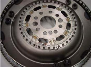
*Flexplate-Drehmomentaufnehmer basierend auf Sensortelemetrie ermöglicht dynamische Leistungsflussfassung des Antriebsstrangs im PKW*
