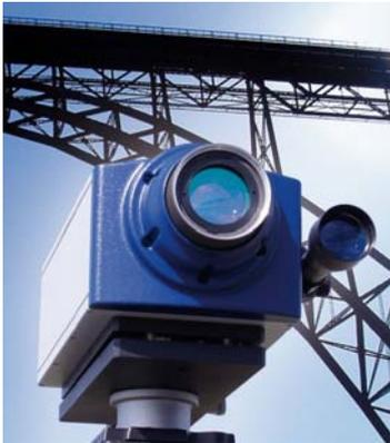
Das RSV-150 Remote Sensing Vibrometer gibt dem Anwender die Möglichkeit, Schwingungen und Verschiebungen auf nahezu beliebigen Oberflächen zu messen, und das über mehr als 300 m Entfernung.
