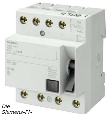
Die Siemens-FI-Schutzschalter Typ F schützen vor elektrischen Schlägen bei Fehlerströmen, wie sie bei einphasigen elektrischen Verbrauchern mit Frequenzumrichtern entstehen können. Sie werden in den Bauvarianten Fehlerstrom-Schutzschalter, FI-Block und kombinierte FI/LS-Schalter eingeführt.
