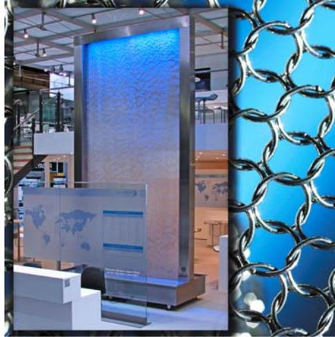
Und alphamesh moduliert. Mit filigraner Leichtigkeit und minimierten Volumen. Abseits gewohnter Bilder. Und gerne auch mit Licht und Wasser. Wie auf der Bau 2013. Da ist die alphamesh Wasserwand der Publikumsmagnet. Aus fünf Metern Höhe stürzt das Wasser in die Tiefe. Gelenkt, gebremst und effektivvoll inszeniert durch einen Vorhang aus vielen Tausend mit einander verwobenen Edelstahlingen. Atemberaubend.
